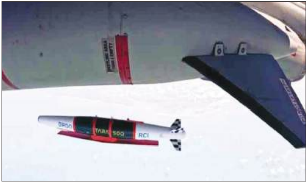
स्वदेशी ग्लाइड हथियार प्रणाली है, जो बिना निर्देशित युद्धक हथियारों को सटीक निर्देशित हथियारों में परिवर्तित करती है. बयान में कहा
